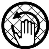
回転体であるため、製品に手や指を触れると怪我の原因になります。危険防止のため身体が触れないように必ず風通しの良い安全カバーを設置してください。また、カバーを開けた時には回転体が急停止するように、安全装置などを設けてください。
