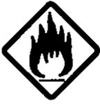
起動・制動時のスリップで火花が発生する事があります。引火・爆発の危険がある油脂・可燃性ガス雰囲気中では絶対に使用しないでください。また、布等燃えやすい所では本体を密閉するようにしてください。密閉する場合は許容仕事率が低下するのでご注意ください。
