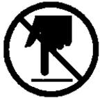
停止状態でも電源をON/OFFすると、アーマチュアは軸方向に動きます。その動く部分を指で触ると挟まれて怪我をすることがあります。必ず安全カバーを設置した後、電源のON/OFFをしてください。
