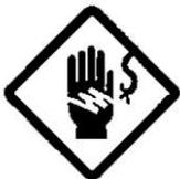
給電部が外部に露出している場合があります。手、指などが触れると感電の恐れがあります。運転中はもちろん保守・点検時など直接触れないようにすると共に、必ず電源を切ってから作業してください。
