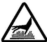
通電だけでもコイルの発熱によって、本体の表面温度は上昇し、触ると火傷をすることがありますのでご注意ください。
