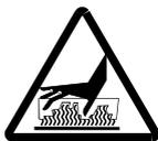
製品の表面温度は、スリップ熱、内蔵コイルの発熱により約90℃～100℃前後に上昇することがあります。手を触れると火傷をしますので、運転中の製品には決して手や指などを触れないでください。また、運転停止後もすぐには温度は下がりません。分解、点検などで製品を触る時には、温度が下がったことを確認後実施して下さい。
