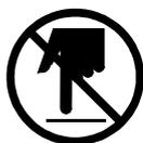
停止状態でも電源をON/OFFをすると、アーマチュアは軸方向に動きます。その作動部を指で触ると挟まれ怪我をすることがあります。必ず安全カバーを設置した後、電源のON/OFFをして下さい。
